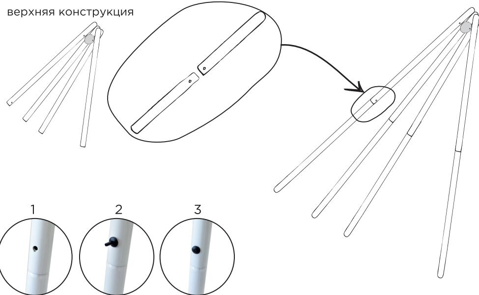
Вставить стойки в кармашки, расположенные по углам текстильной основы. Нужно начинать вставлять в кармашки в узкой верхней части.
